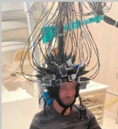
MEG avec 48 capteurs 144 canaux.
